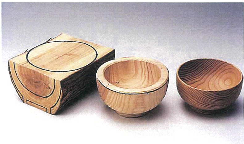
直径 15cm の小径木でも椀ができる半割工法
