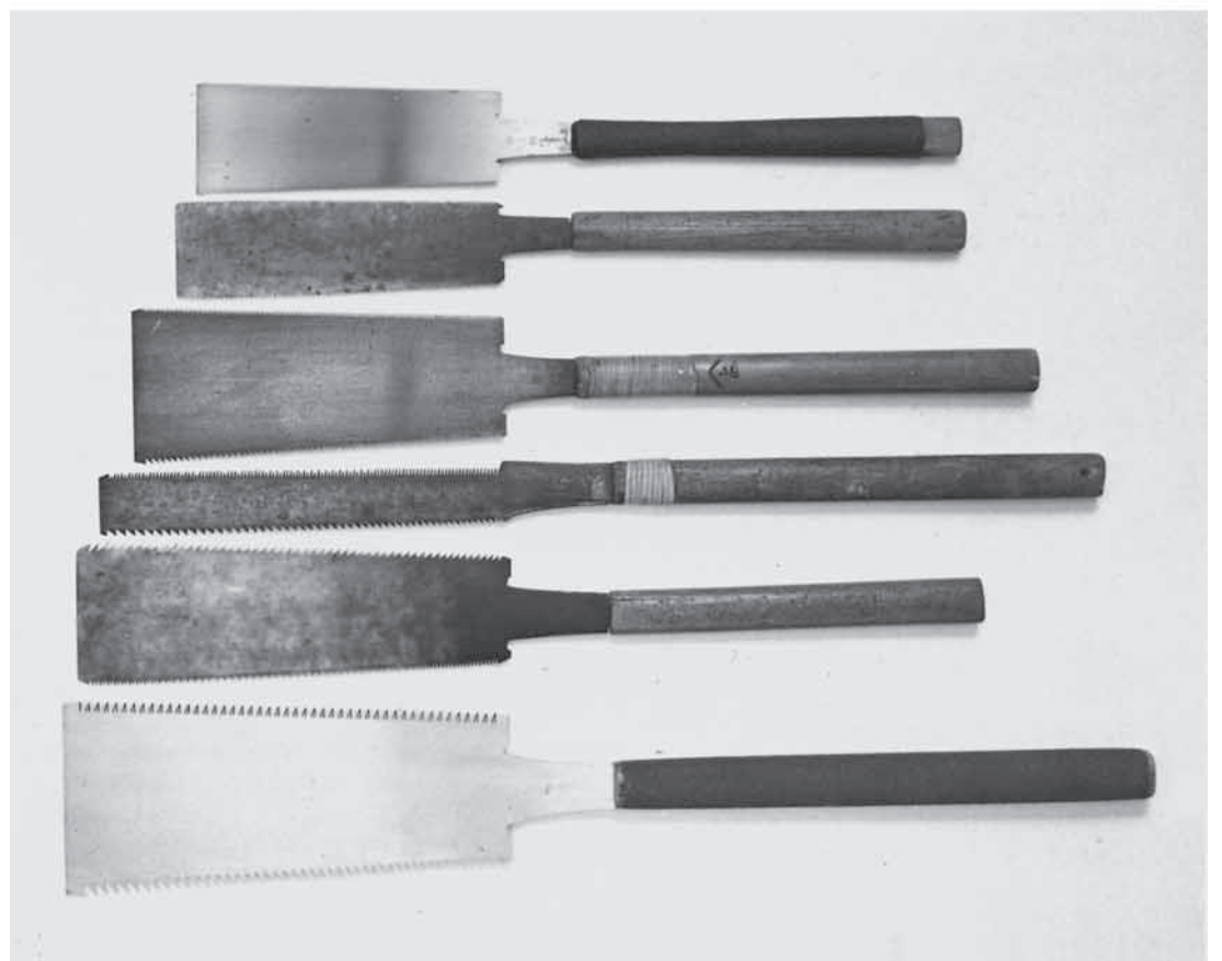
▼りょうばのこぎり（両刃鋸）。中央は1尺の両刃の、使い込まれて鋸身が極端に狭くなったもの。こうなってもまだ使える。
