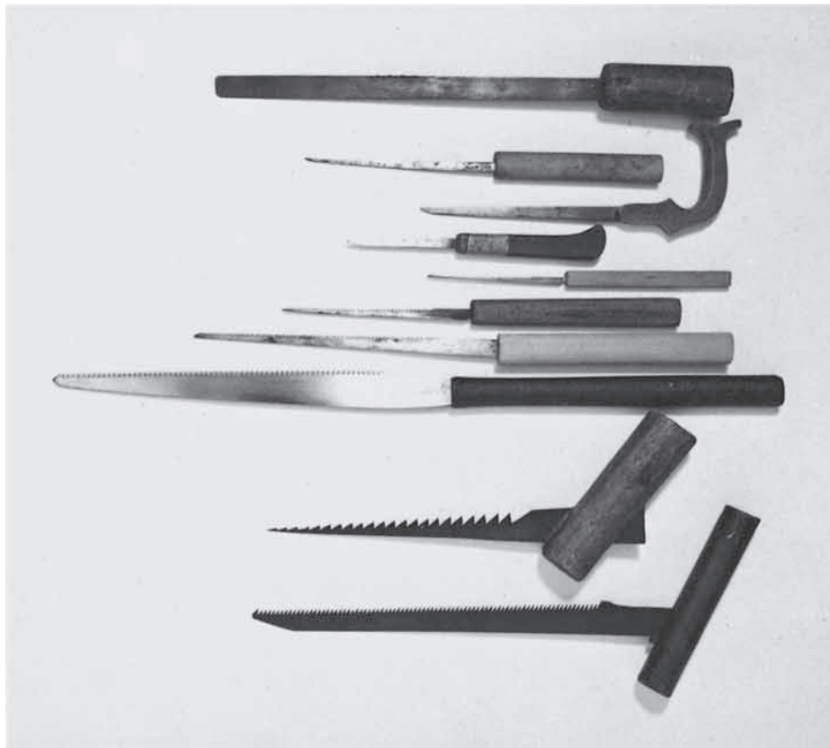
▼まわしひきのこぎり（廻挽鋸）のいろいろ。上端は、つんぬきといい、桐下駄の木取用の鋸。4～5枚の歯が鋸身から直角に生えている。上から2番めの廻挽鋸と組んで使う。
